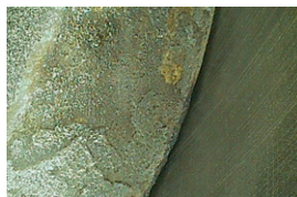
Abb. 4 Kohleablagerungen am Kolbenboden
