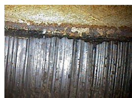
Abb. 1 Defekte Oberfläche einer Laufbuchse
