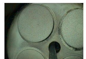
Abb. 3 Ascheschicht auf dem Zylinderkopf
