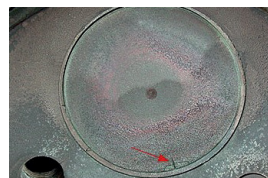
Abb. 7 Ventil mit Riss
