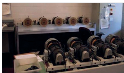
Abbildung B DIN 51821 (FAG FE9) Wälzlager-Prüfgerät
